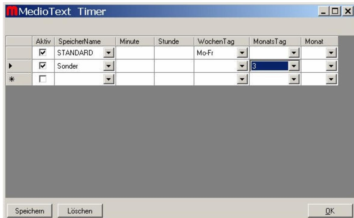
Das Lauflicht überprüft fortlaufend, ob ein neuer Timer aktiv wird. Sofern dies nicht der Fall ist, wird der vorhandene Text abgespielt. Sobald ein Timer aktiv wird, wird der zugehörige Speicher abgespielt. Wenn mehrere Timer zur gleichen Zeit aktiv werden, wird der erste Timer in der Liste verwendet.
